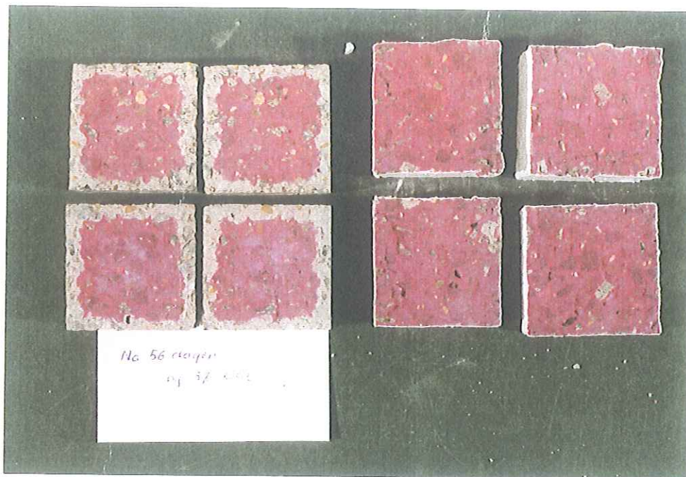
Fig. 5: Eprouvtes fendées aprs 56 jours de conservation (3 % CO 2 ) De gauche à droite: Eprouvte 7 et 8 (non-traitées) Eprouvte 15 et 16 (avec coating)
