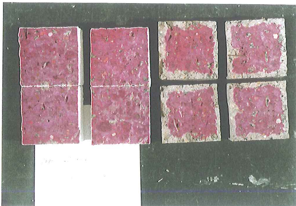
Fig. 4: Eprouvtes fendées aprs 28 jours de conservation (3 % CO 2 ) De gauche à droite: Eprouvette 13 et 14 (avec coating) Eprouvette 5 et 6 (non-traitées)
