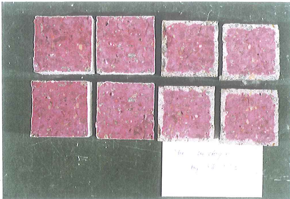
Fig. 3: Eprouvtes fendées aprs 14 jours de conservation (3 % CO 2 ) De gauche à droite: Eprouvette 11 et 12 (avec coating) Eprouvette 3 et 4 (non-traitées)
