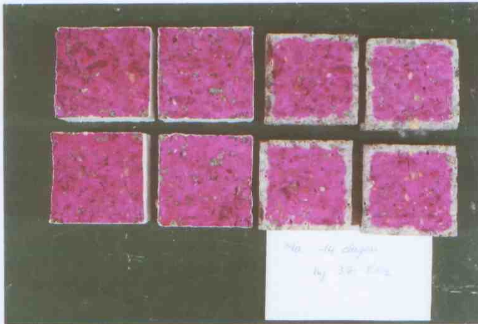
Fig. 3: Eprouvettes fendées après 14 jours de conservation (3 % CO 2 ) De gauche à droite: Eprouvette 11 et 12 (avec coating) Eprouvette 3 et 4 (non-traitées)
