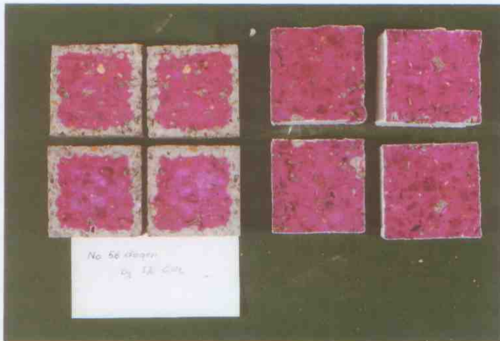
Fig. 5: Eprouvettes fendées après 56 jours de conservation (3 % CO 2 ) De gauche à droite: Eprouvette 7 et 8 (non-traitées) Eprouvette 15 et 16 (avec coating)
