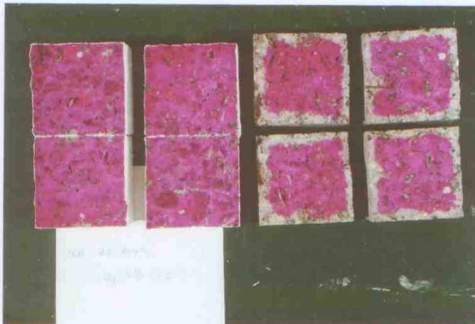
Fig. 4: Eprouvettes fendées après 28 jours de conservation (3 % CO 2 ) De gauche à droite: Eprouvette 13 et 14 (avec coating) Eprouvette 5 et 6 (non-traitées)
